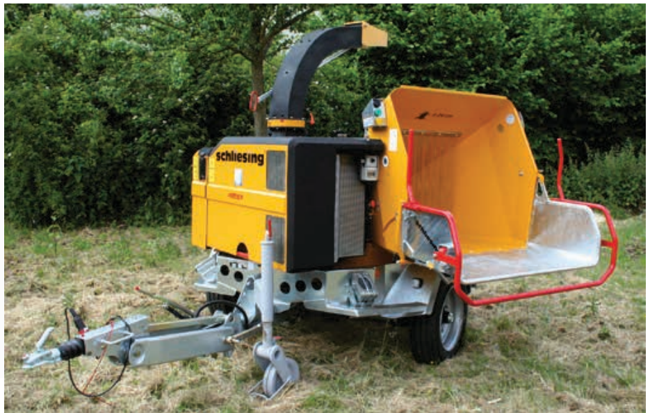
Der neue Holzzerkleinerer 495 EX ist für Aststärken bis 24 cm Durchmesser ausgelegt. | Fotos: Schliesing
